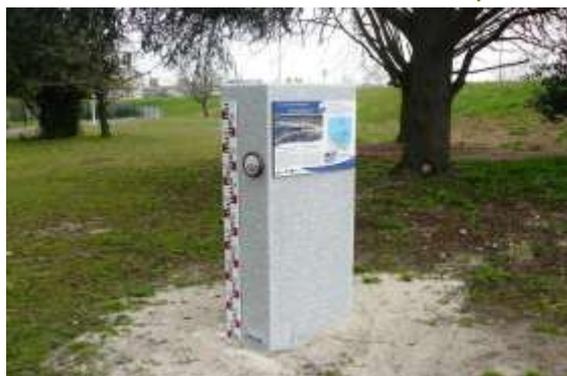
Afin de se souvenir des inondations de la Loire, des repères de crues et un limnimètre (appareil de mesure du niveau de l'eau) ont été installés sur la commune, grâce au financement de l'Établissement Public de Loire.
